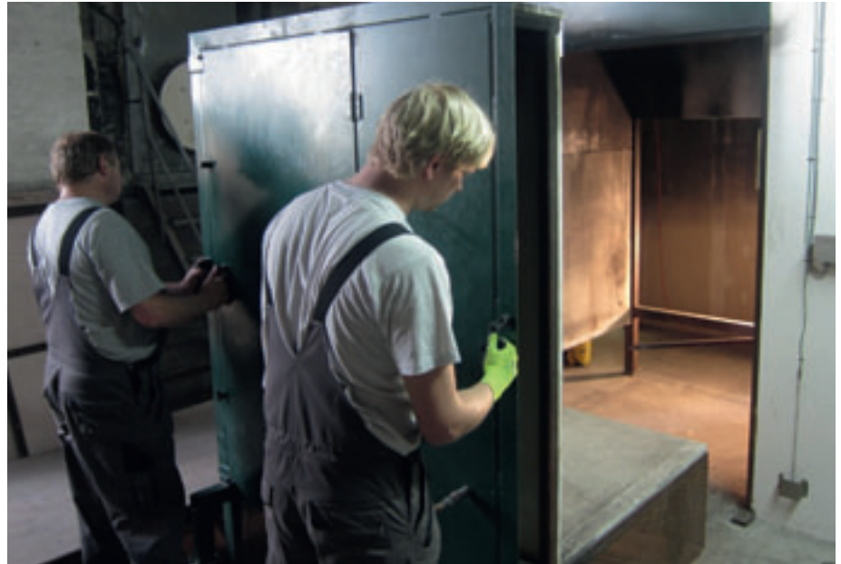
In der Materialforschungs- und Prüfungsanstalt Leipzig wurden die Prototypen der Fassadenelemente getestet. Ergebnis der Brandprüfung: nicht brennbar
