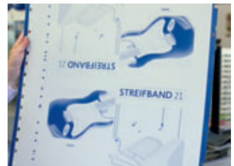
Im Bild: Eine Druckplatte, wie sie aktuell in verschiedenen Druckverfahren verwendet werden. Diese Druckplatten werden auf runde Zylinder gespannt, mit Farbe benetzt (für jede der vier Farben Cyan, Magenta, Gelb und Schwarz je eine Platte und ein Zylinder) und übertragen die Farbe aufs Papier.
