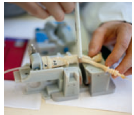
Im Kunststofflabor der Arbeitsgruppe Innovative Surgical Training Technologies: Hier werden die Modelle hergestellt, welche die Chirurgen später „operieren“. Die Modelle bestehen aus verschiedenen Kunststoffen, die sich echt anfühlen sollen. Bis es soweit war, mussten die Wissenschaftler viele Mischungen, Verfahren und Stoffe ausprobieren
